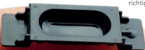
Der Chip, der für die IMPACT-Technologie steht, ist nur 0,7 x 2,2 Zentimeter groß. In ihm sind die notwendigen „Zutaten“ (Reagenzien) fixiert, die später mit der Probe reagieren. Die Reagenzien sind für das bloße Auge unsichtbar. Foto: Roche Diagnostics Deutschland GmbH
